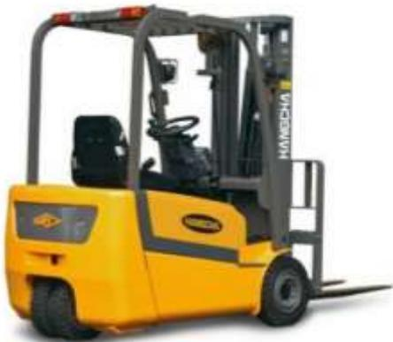
Тип погрузчика: Электрический 3-х опорный
